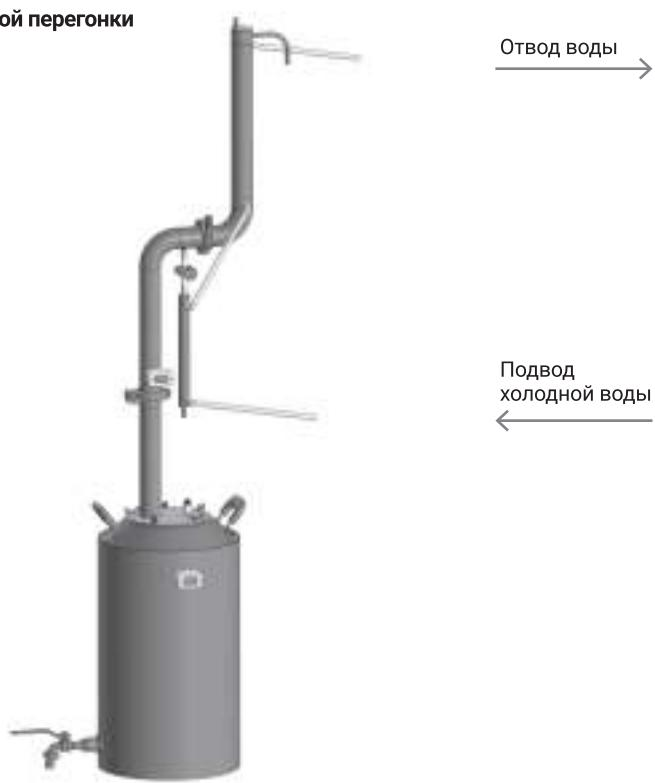
Для второй дробной перегонки колонна собирается в конфигурации с царгой, заполненной насадкой, совмещенным узлом отбора по жидкости с зажимом Гофмана, основным холодильником (верхним) и холодильником-доохладителем (нижним). Вода охлаждения подается последовательно на нижний штуцер доохладителя, потом – с верхнего штуцера доохладителя на нижний штуцер основного холодильника, и с верхнего штуцера основного холодильника – в сток.
